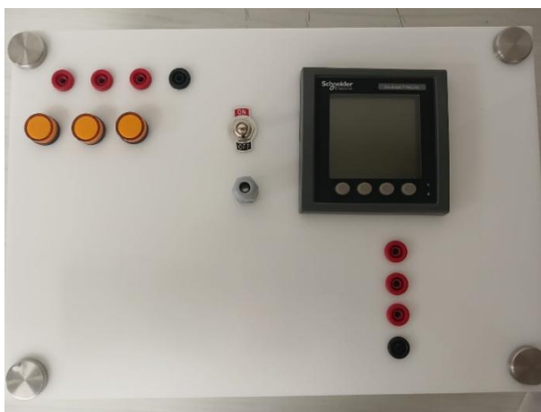
Figura 16 Montaje analizador PM 2230 Fuente: Autores
