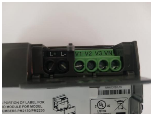
Figura 18 Detalle señales de tensión PM2230 Fuente: Autores
