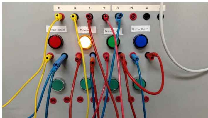
Ilustración 73 Activación de la bomba en modo manual
