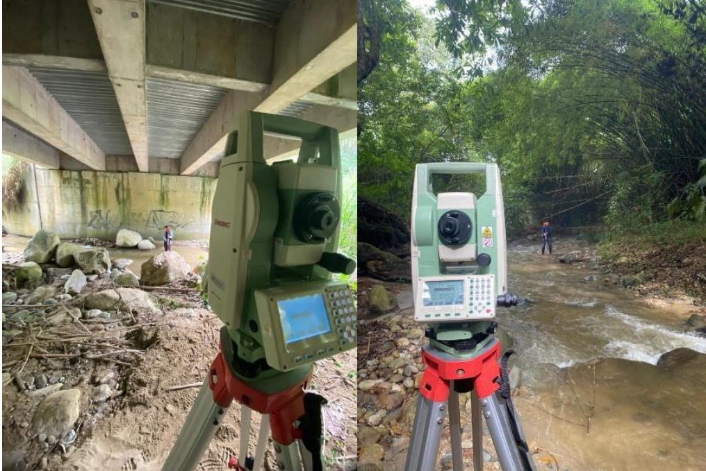
Figura 4. Levantamiento de información mediante estación total
