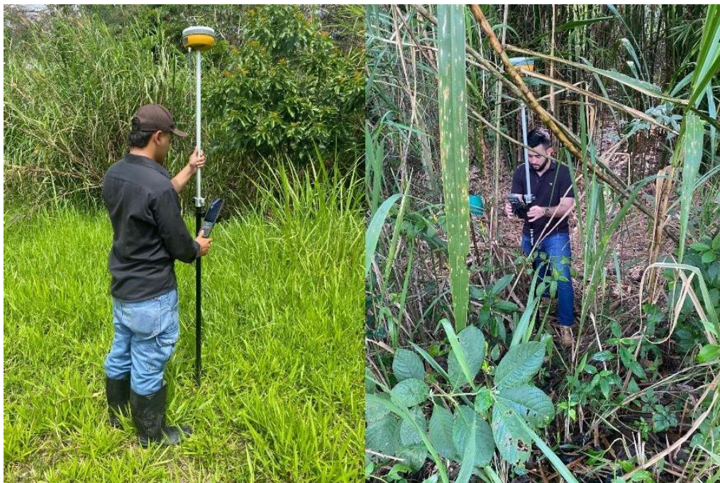
Figura 3. Levantamiento de información mediante receptor GNSS RTK
