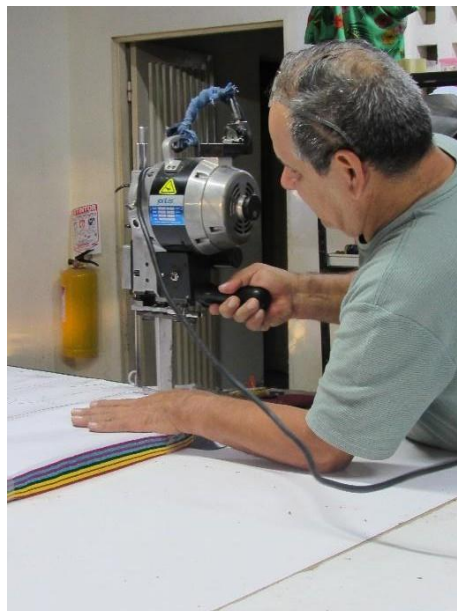
a. Corte de las capas de tela con la cortadora eléctrica.
