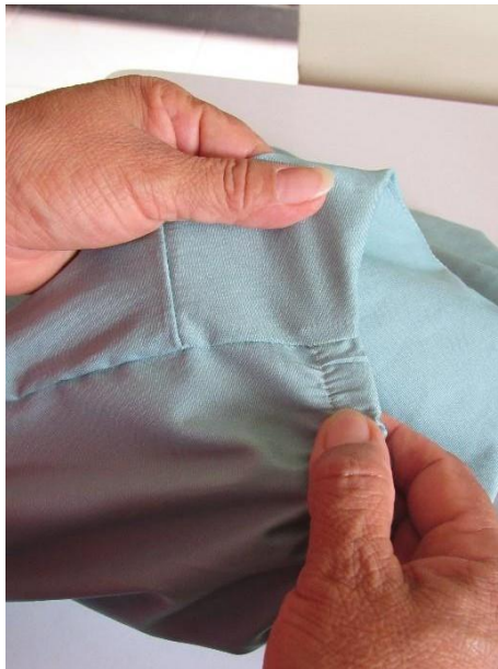
a. Revisión de costuras y acabados.
