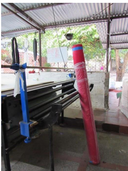
a. Rollo seleccionado y dispuesto para el tendido.
