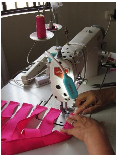
c. Ensamble y acabado mediante máquina plana.
