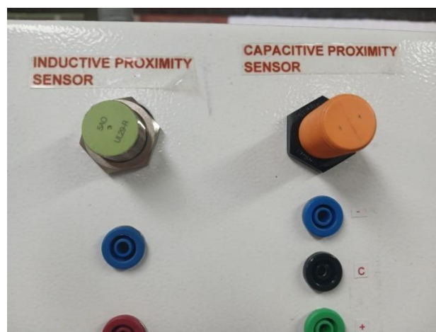
Figura 27 Montaje sensores capacitivos 3 hilos módulo de accionamientos Fuente. Autores
