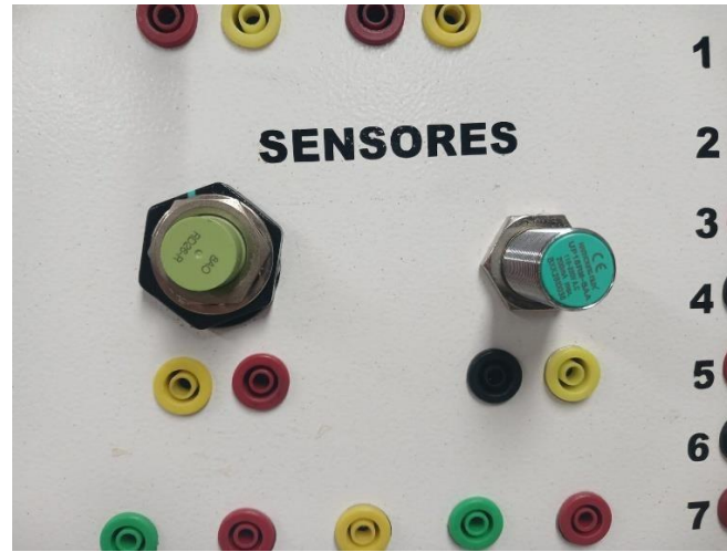
Figura 26 Montaje sensores de proximidad inductivos de 2 hilos modulo accionamientos Fuente. Autores
