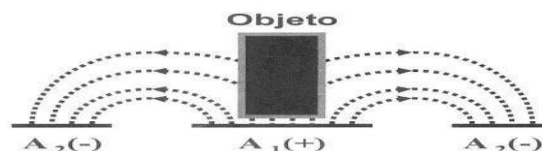
Figura 15 Efecto producido por un objeto que penetra en el campo eléctrico creado por el condensador abierto Fuente: Autómatas Programables (Mandado, et al, 2009)
