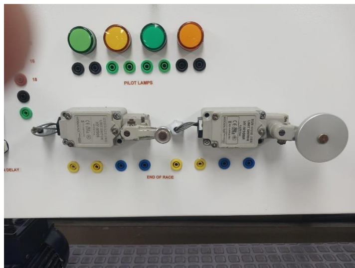
Figura 25 Montaje finales de carrera modulo accionamientos Fuente. Autores
