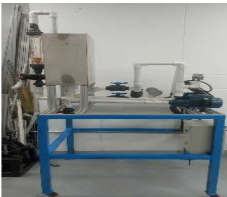
Figura 18. Módulo de bombas en serie y paralelo
