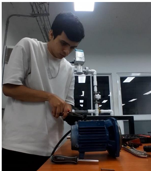
Figura 7. Desmontaje de componente de bomba y revisión eléctrica
