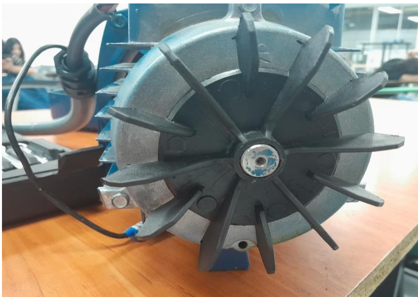
Figura 8. Cambio de ventilador
