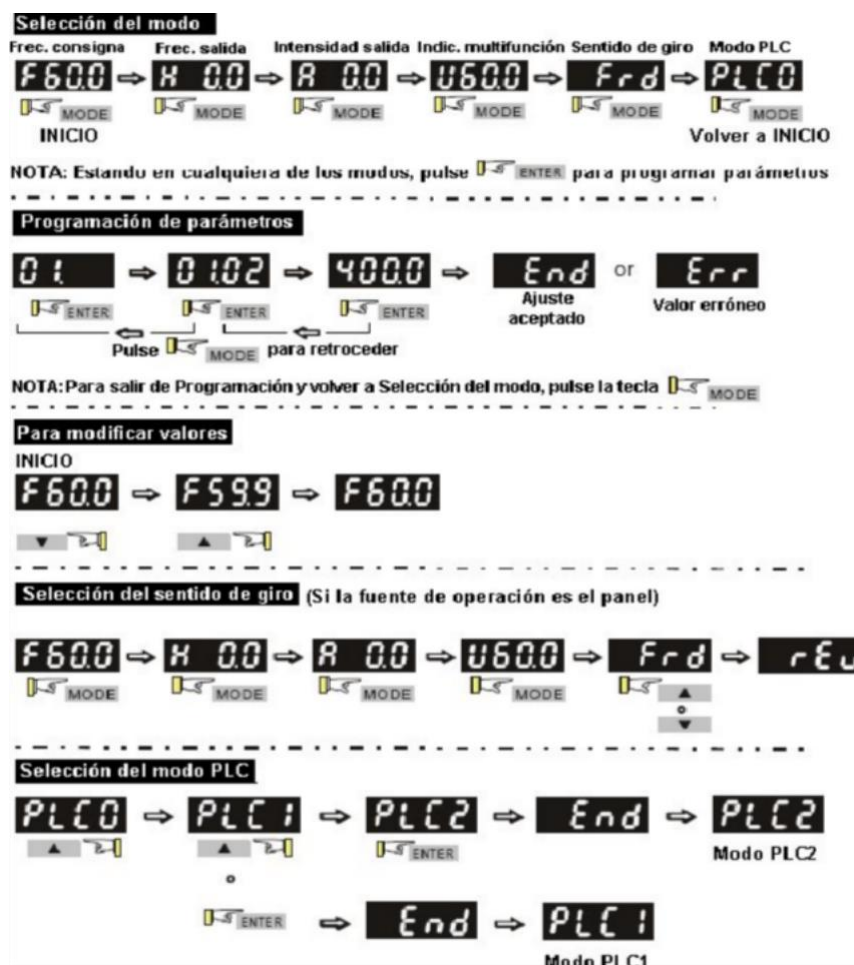
Figura 18 Guía de operación de teclado DELTA MS 300 Fuente: Manual Delta 2023
