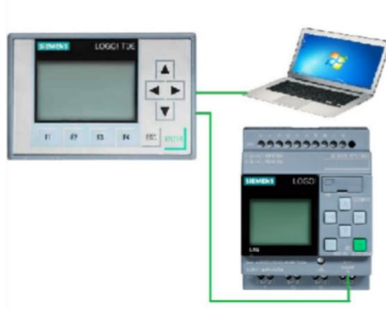
Figura 24 Conexión Logo V8 y terminal de dialogo HMI TDE
