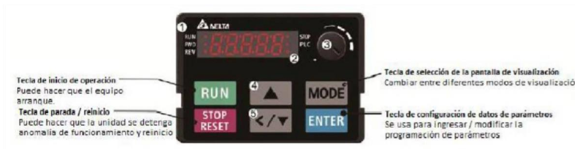
Figura 16 Terminal de programación convertidor DELTA MS 3003 Fuente: Manual Delta 2023
