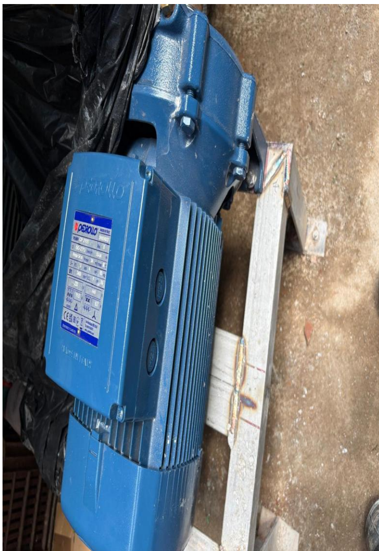
Figura 32 Bomba sistema aspersión.
