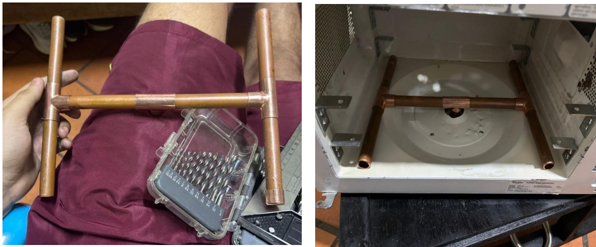
Figura 19. Prototipo de distribuidor de flujo de aire caliente en configuración tipo H de cobre
