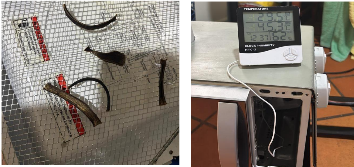
Figura 18. Registro de variables psicométricas mediante el termohigrómetro HTC-2 durante ensayo 2
