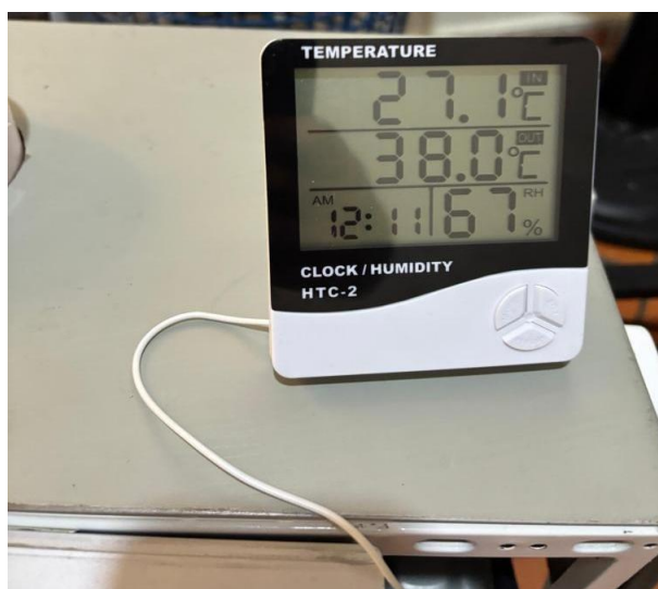
Figura 20. Registro de variables psicométricas mediante el termo-higrómetro HTC-2 durante ensayo 3
