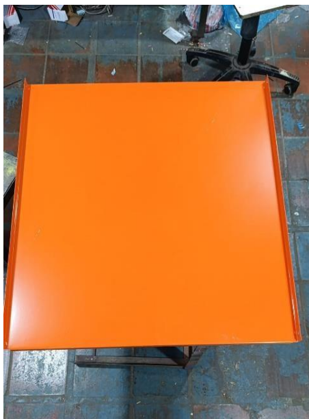
Imagen 88. Presentación de lámina doble fondo inicial para tablero UPS. (Autores, 2025)
