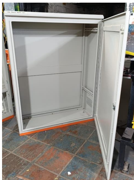
Imagen 87. Presentación de disposición interna de envolvente en fabricación. (Autores, 2025)
