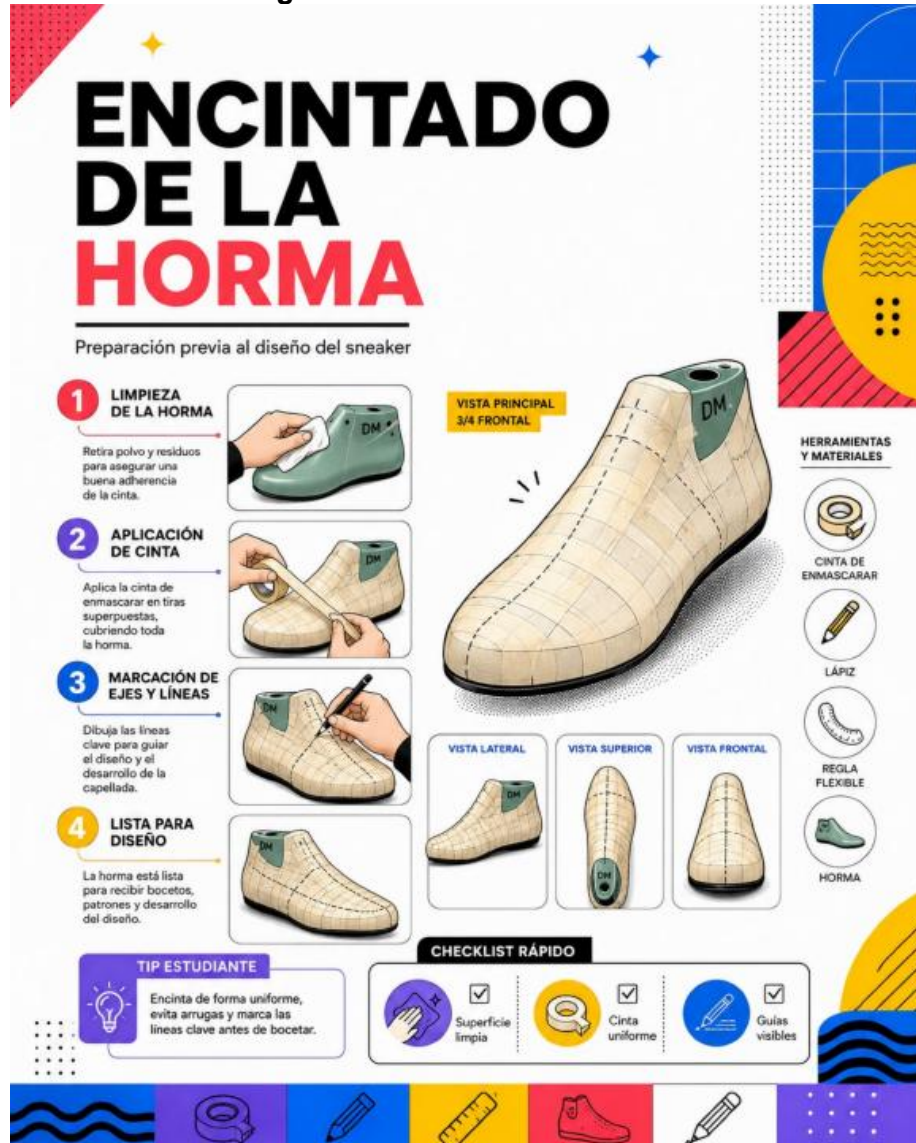
Figura 14. Encintado de la horma
