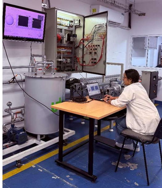
Figura 11. Pruebas de funcionamiento del banco de presión y Caudal
