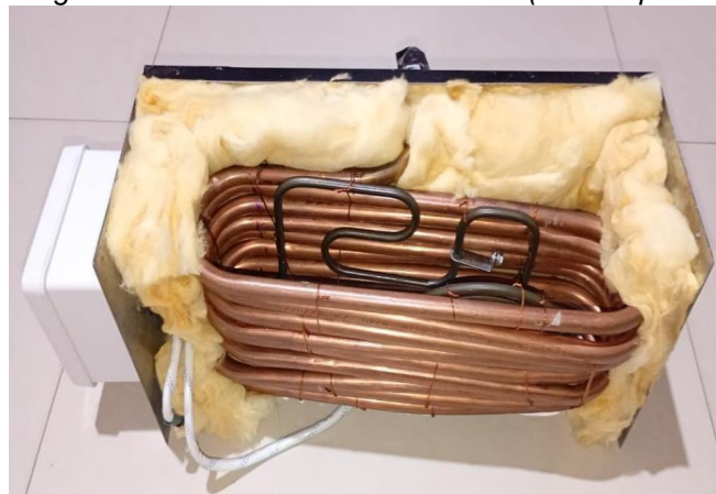
Figura 33. Calentador con aislamiento (lana de piedra)
