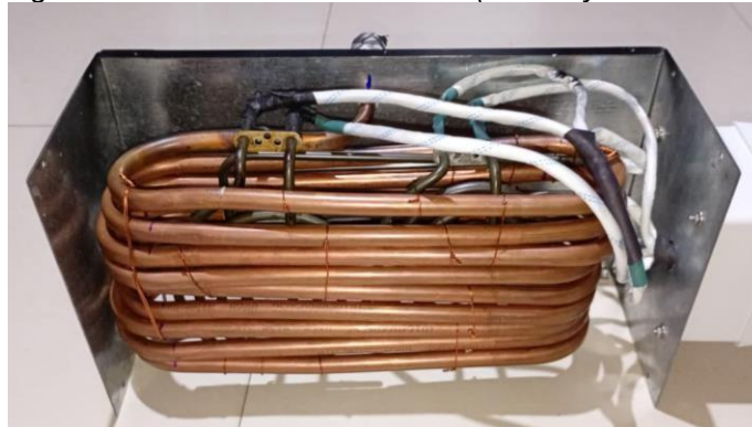
Figura 32. Calentador internamente (tubería y resistencias)
