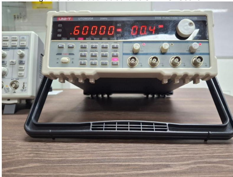
Figura 9. Generador de señales UNI-T UTG9020A
