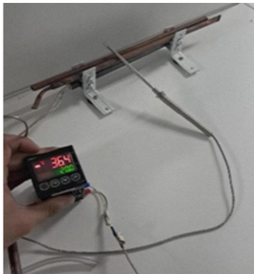
Figura 15. Soporte para el tubo de calor y resistencia térmica
