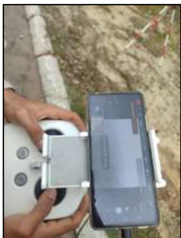
Figura 18 Equipo control de Dron
