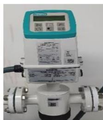
Figura 1. Medidor de caudal siemens MAG6000.
