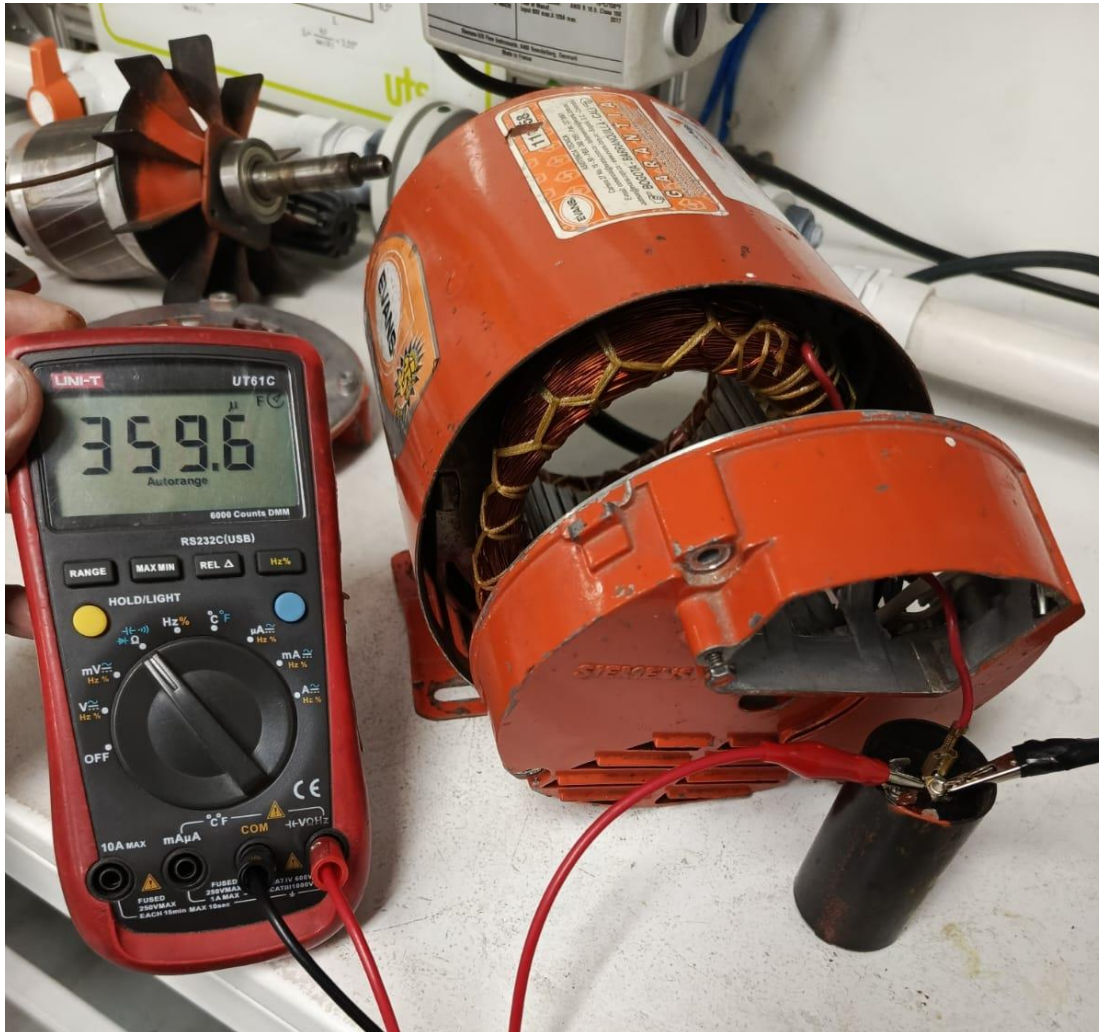
Imagen 8. Diagnóstico y medición de componentes eléctricos de las electrobombas
