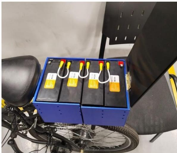
Fuente: conexión en serie de baterías 12V
