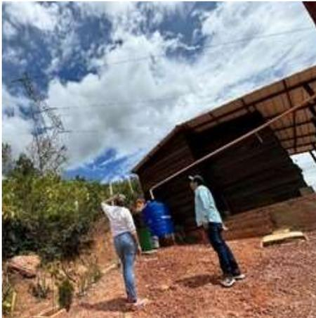
se observó una vivienda rural, de estructura liviana, techo en lámina metálica y paredes en madera, a pocos metros de la vivienda se destaca la proximidad crítica de la línea de alta tensión a la estructura habitada ya que está en un punto crítico de afectación dentro del margen de seguridad inadecuado
