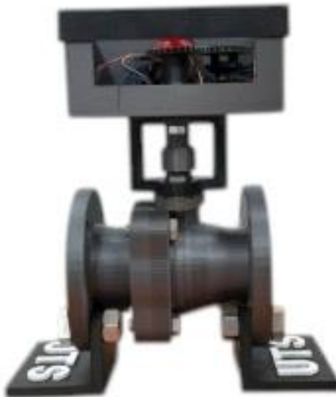
Imagen 5. Válvula con su sistema de Automatización
