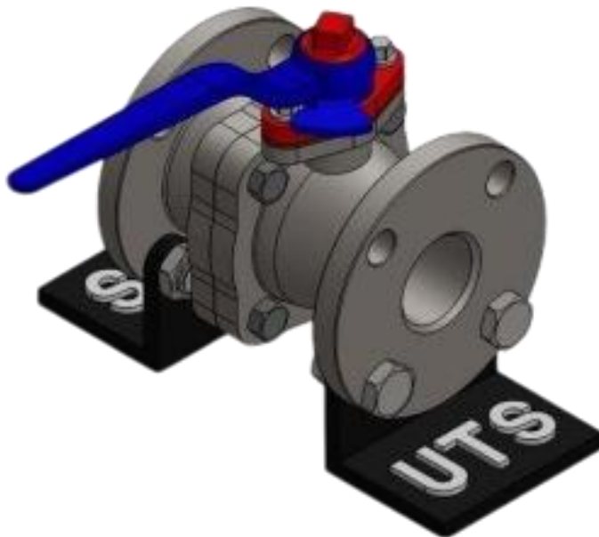
Imagen 1. Ensamble de la Válvula, mediante modelado CAD
