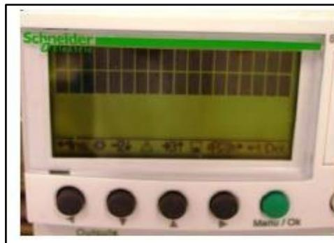
*Nota.* Tomado de pantalla LCD no funciona correctamente, de Schneider Electric,2012,
