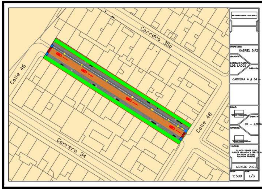
Ilustración 27.Planta ciclorruta fuente propia.
