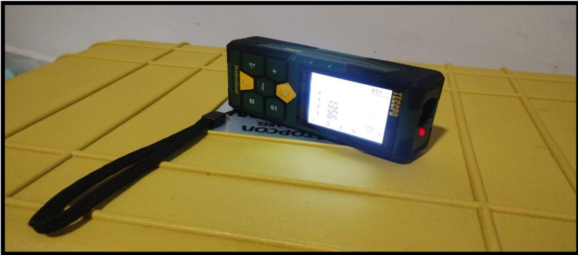
Figura 6. Equipo utilizado distanciómetro de mano.
