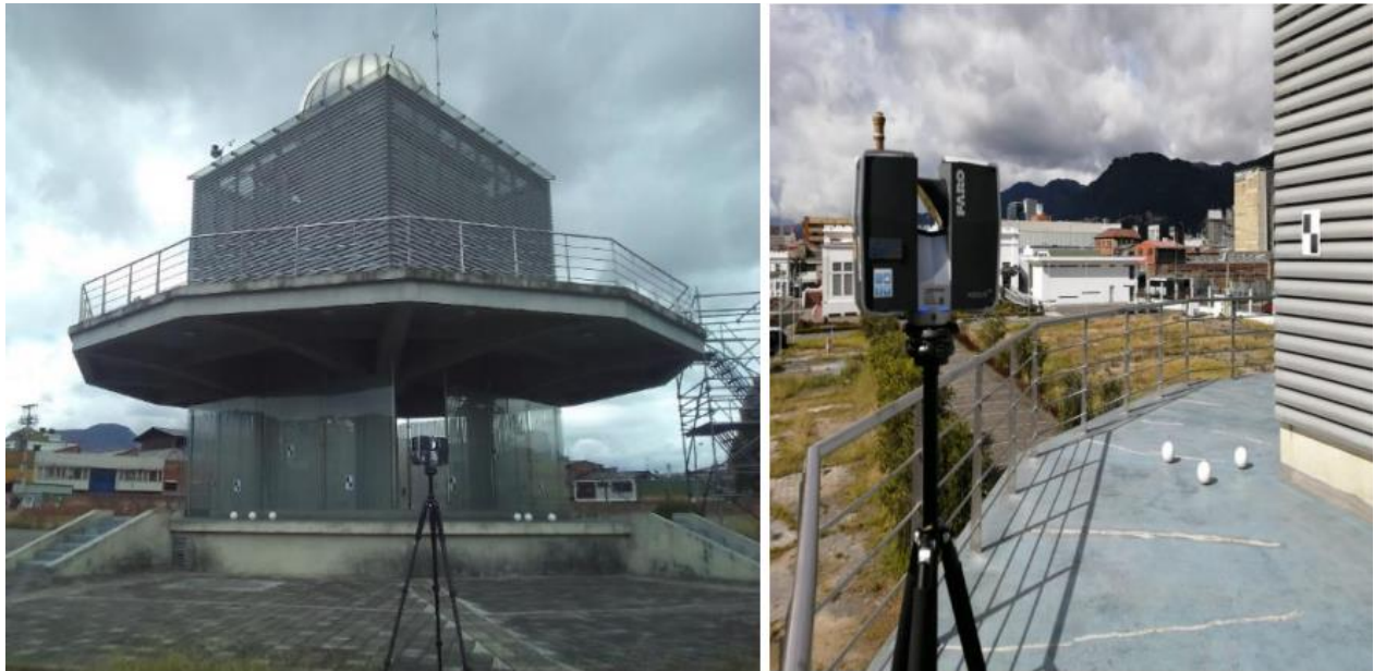
Figura 1 :Proceso de recolección de información con el escáner laser. Fuente: (Bernal Vaca & Ramírez Niño 2020)
