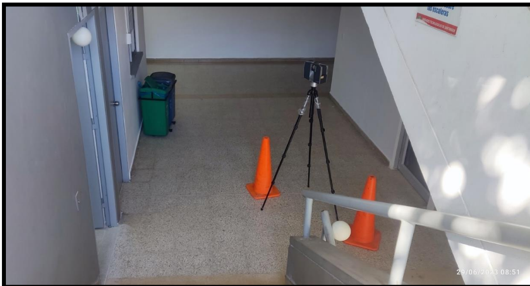
Figura 16 Esferas de referencia instaladas
