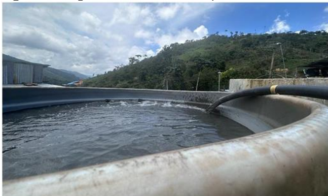
Figura 13. Agua Recirculada en el proceso de beneficio
