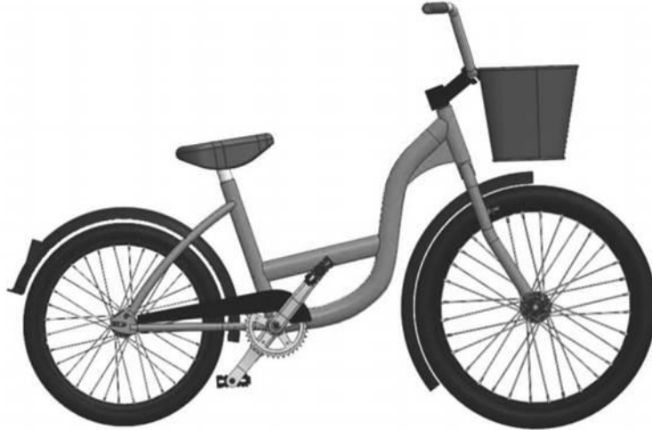
Figura 10. Modelado paramétrico de una bicicleta de paseo (Durán & Laguado , 2015)
