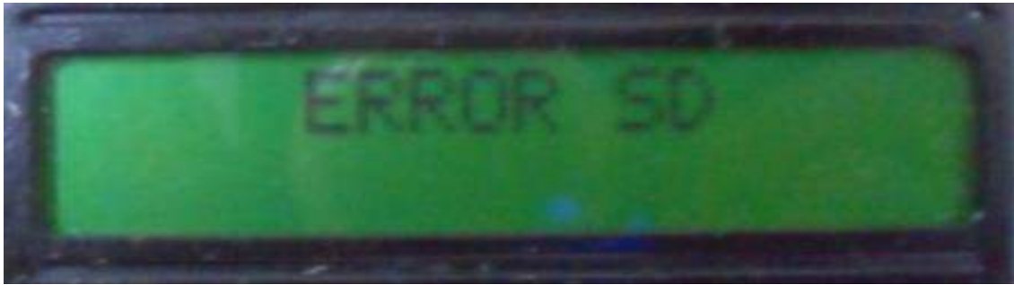
Figura 5. Mensaje de error en el test de la memoria SD.
