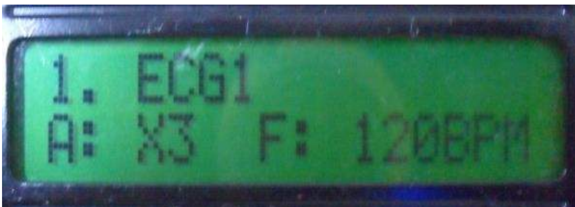
Figura 14. Reproducir señal con amplitud X3 y frecuencia de 120BPM.
