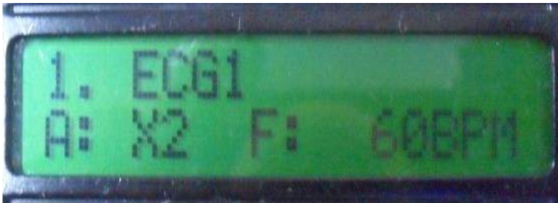
Figura 13. Reproducir señal con amplitud X2 y frecuencia de 60BPM.
