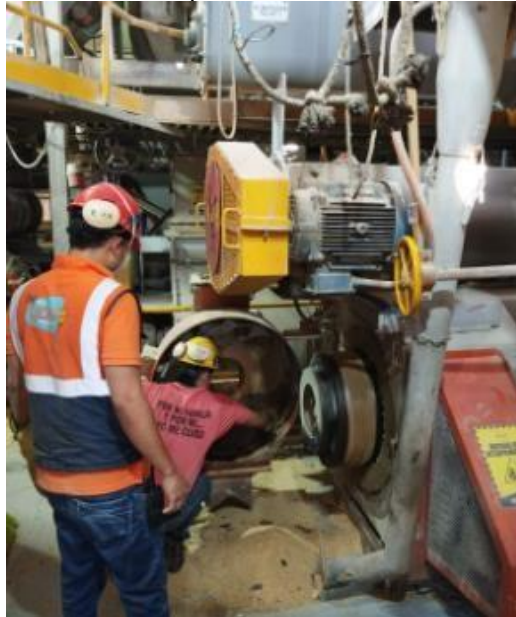
Figura 9. Recorrido en planta, atascamiento de maquinaria.
