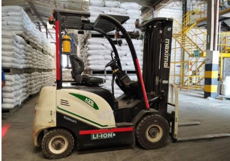
Figura 10. Modelo de montacargas eléctrico en planta 2.
