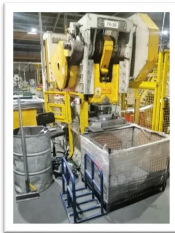
Figura 3. Troqueladora automática del área de troquelaría
