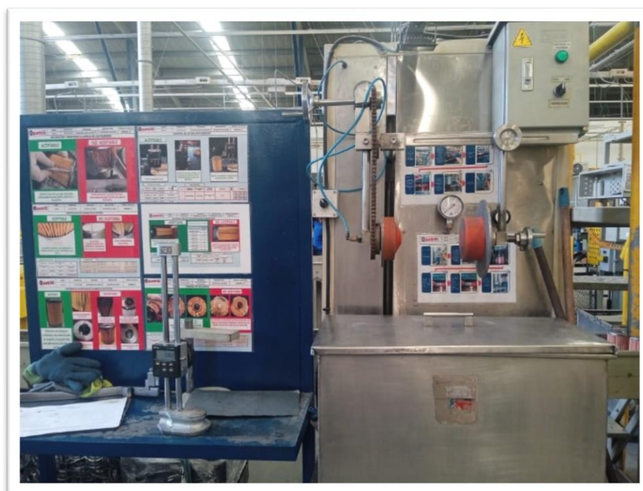
Imagen 14. Prueba de burbuja y desgarré
