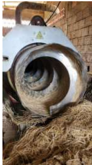
Ilustración 10. vaciado de plumas del escurridor
