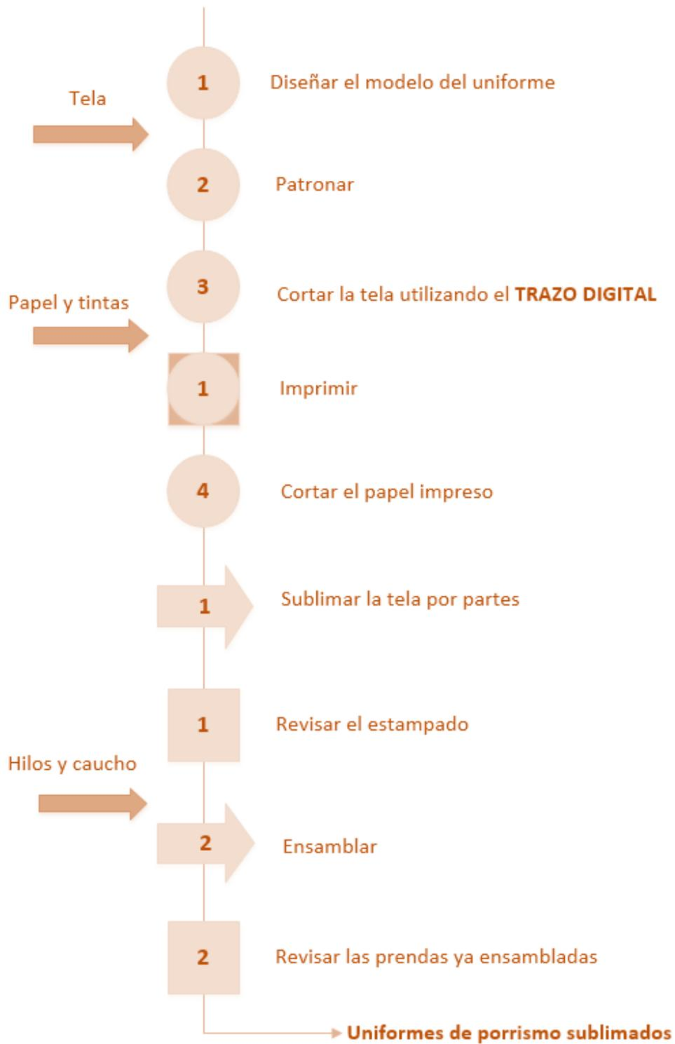
En este nuevo diagrama se agregó el trazo digital en la operación del corte.
