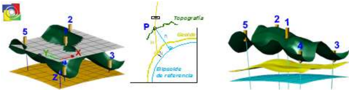
Figura 16. Sistemas de referencia altimétricos
