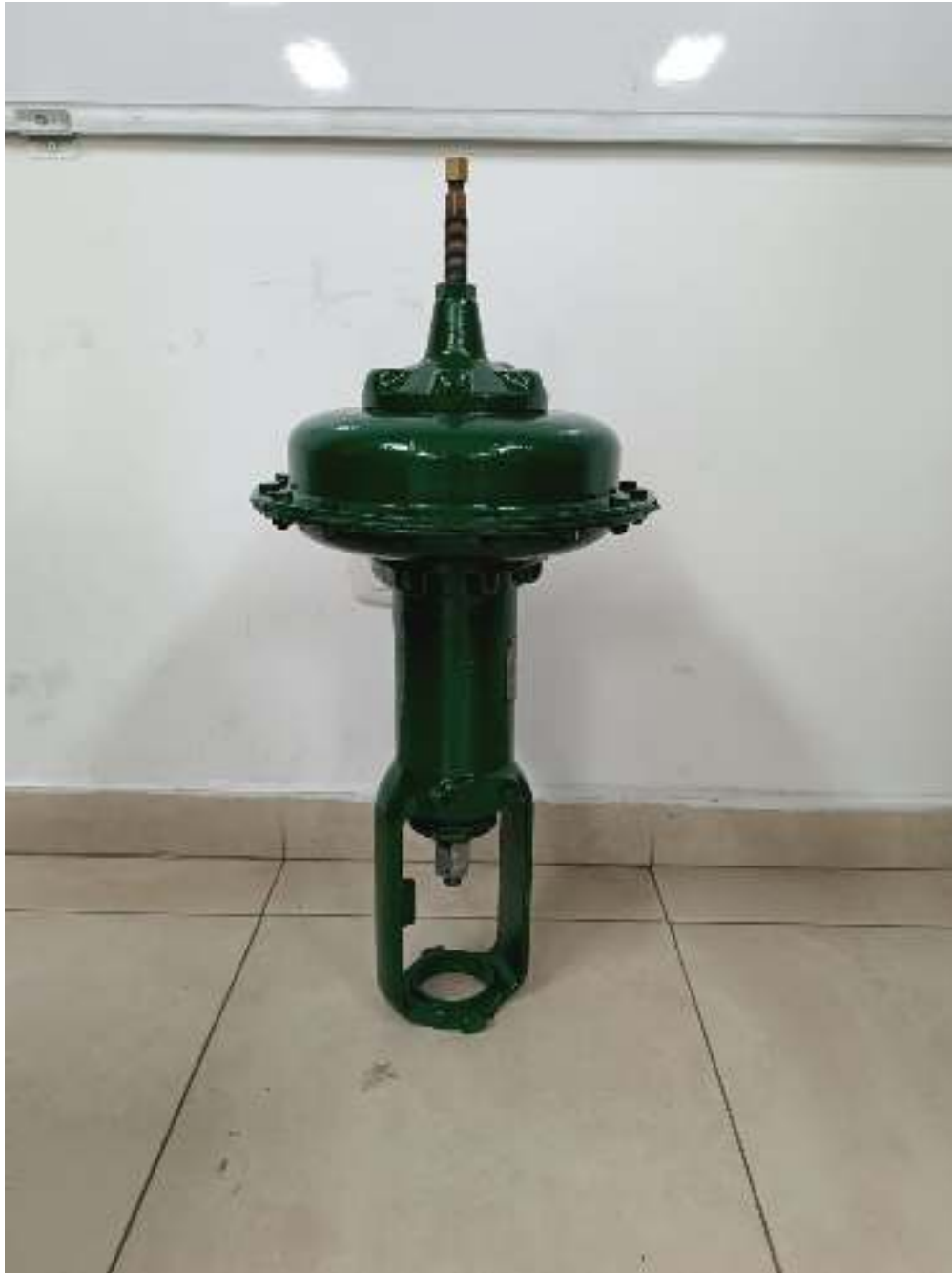
Figura 51 Intervención de pintado del actuador de una válvula.
