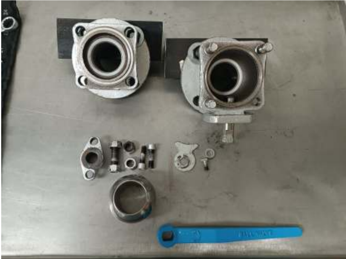
Figura 46 Mantenimiento preventivo a Válvulas tipo cuerpo partido.
