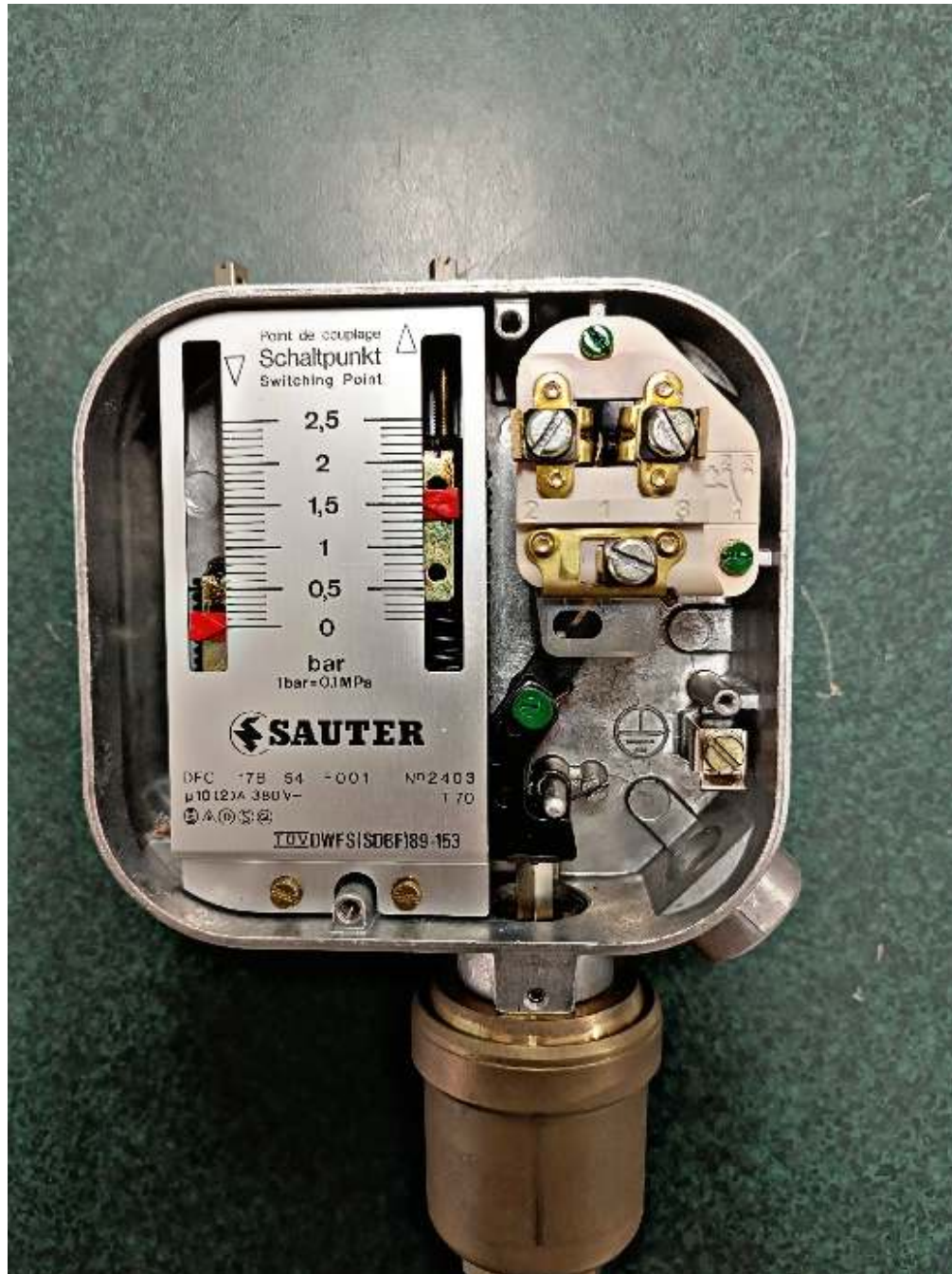
Figura 34 Ajuste de rangos al presostato.
