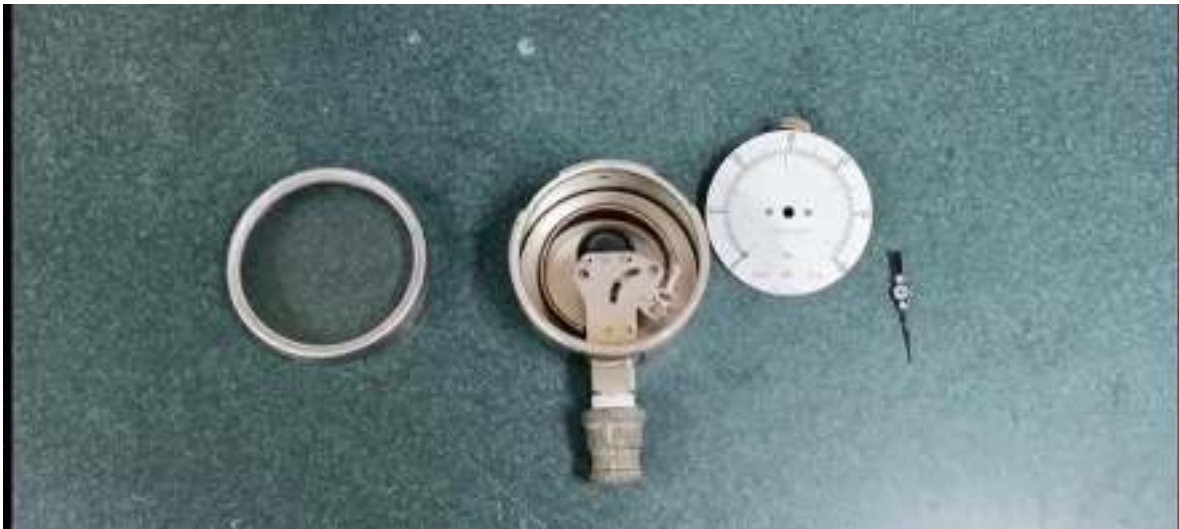
Figura 31 Mantenimiento a manómetros.
