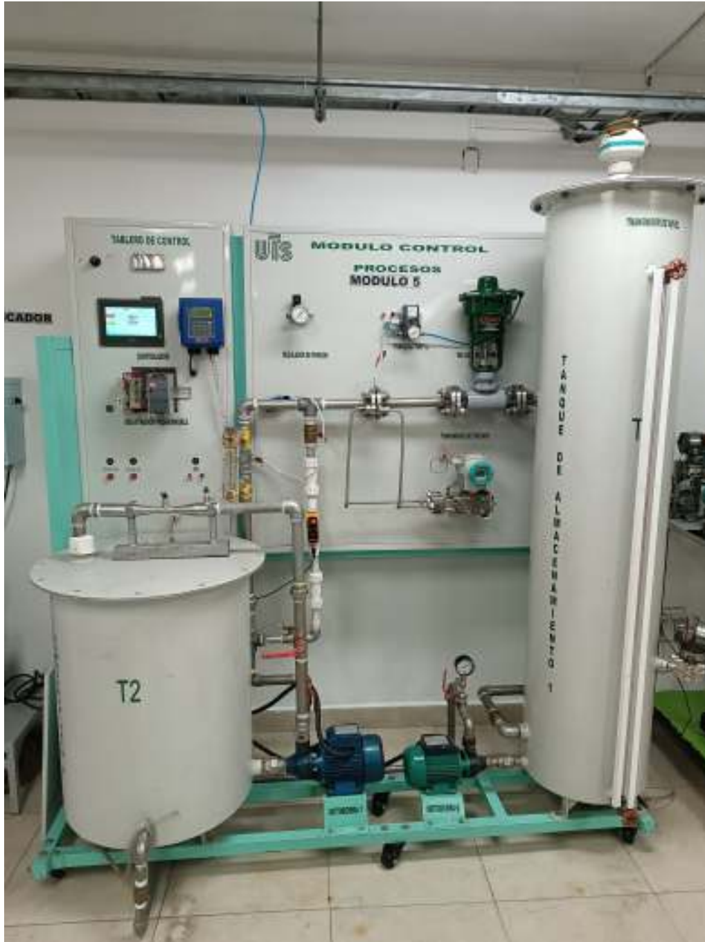
Figura 22 Modulo 5 de control de caudal
