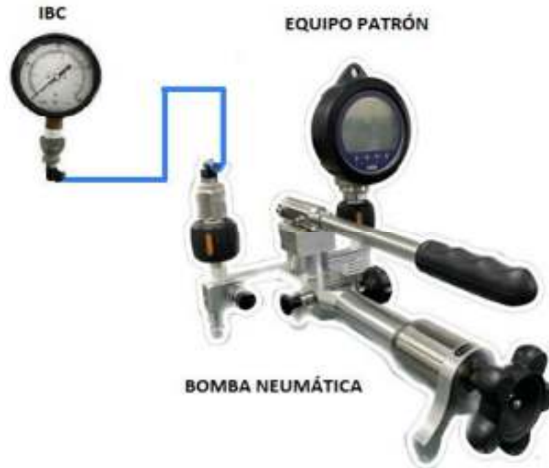
Figura 10 Conexión de bomba neumática.
