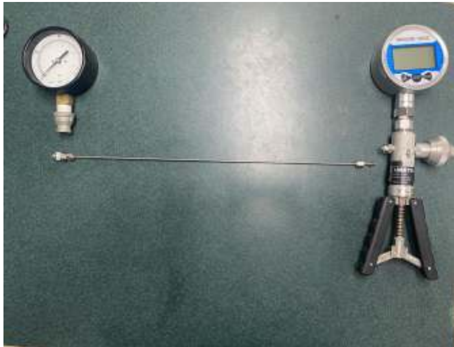
Figura 9 Conexión de bomba neumática AMETEX T-970 + Manómetro.
