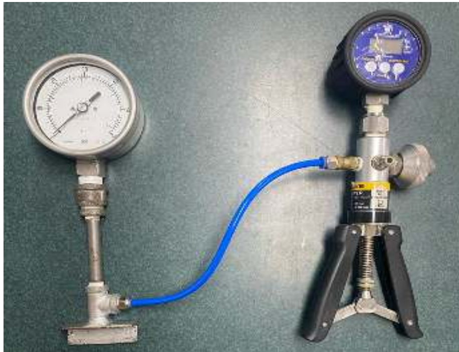
Figura 7 Conexión bomba neumática FLUKE 700 PTP + Manómetro.
