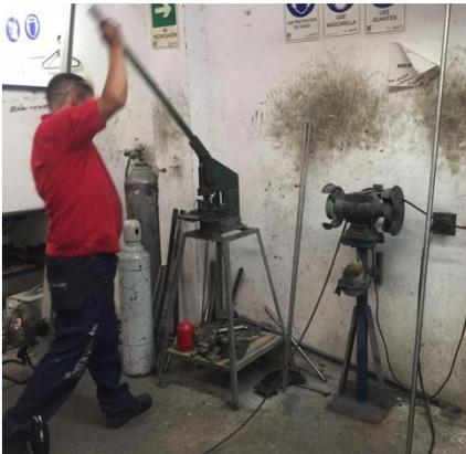
Se llama troqueladora a la máquina encargada de ejercer presión sobre un troquel o matriz para cortar un material, esta se puede ajustar a la altura deseada, ya que todos los troqueles no tienen el mismo tamaño.
