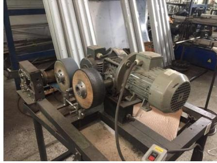
Consiste en pulir salientes o bordes, así como soltar remaches, redondear ángulos, cortar metales, etc. Por ello, la industria las requiere de manera permanente para varios procesos en los que involucre bruñido, afilado o bordeado de superficies.
