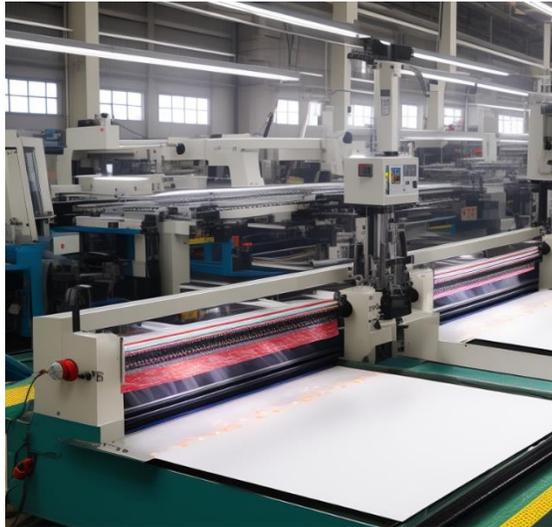
*Nota.* Las cortadoras de tela automatizadas serán una parte esencial del proceso de confección de la empresa, pues permiten un corte preciso de las telas, reduciendo el desperdicio de material y mejorando la eficiencia en la producción. Con control numérico, garantizarán que cada pieza de tela tenga las dimensiones adecuadas para la confección.
