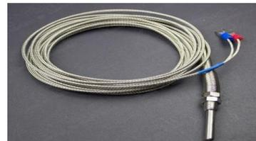
Las termocuplas son el sensor de temperatura más común utilizado industrialmente. Una termocupla se hace con dos alambres de distinto material unidos en un extremo (soldados generalmente). Al aplicar temperatura en la unión de los metales se genera un voltaje muy pequeño (efecto Seebeck)
