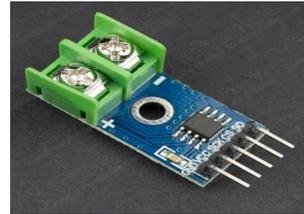
La tarjeta de control MAX6675 realiza la compensación y linealización de la respuesta del sensor con un ADC. La resolución es de 0.25o y el rango de uso de la tarjeta es de 3.0V a 5.5V, por lo que la puedes utilizar con cualquier Microcontrolador o tarjeta de desarrollo como un Arduino.
