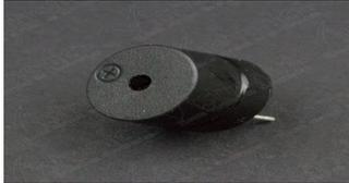
Zumbador magnético en empaque plástico SOT. Este CI utiliza unión de oro, tiene un proceso de producción compleja, larga vida, funcionamiento estable, y es un producto de alta calidad. Es ampliamente utilizada en aparatos eléctricos del hogar, teléfonos móviles, ordenadores, equipamiento médico, sistemas de alarma, máquinas de posición, sistema del control de acceso, juguetes, etc.
