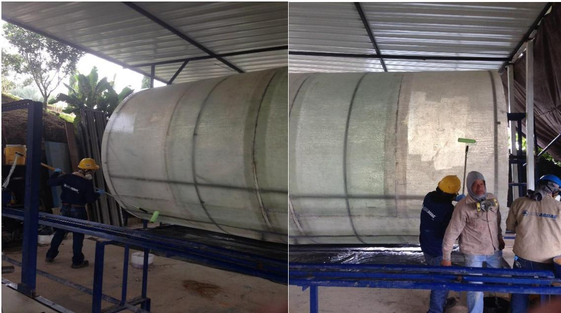
Figura 11. Preparación del hilar para la fibra de vidrio
