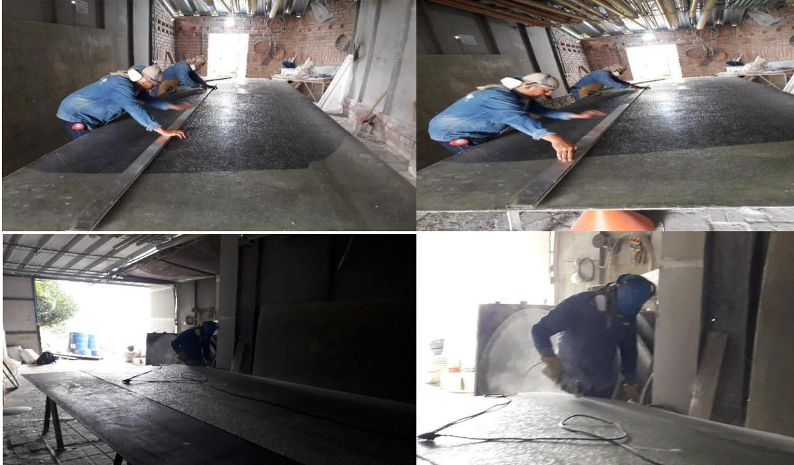
Figura 4. Procedimiento para acoplar la lamina y volverla un cilindro
