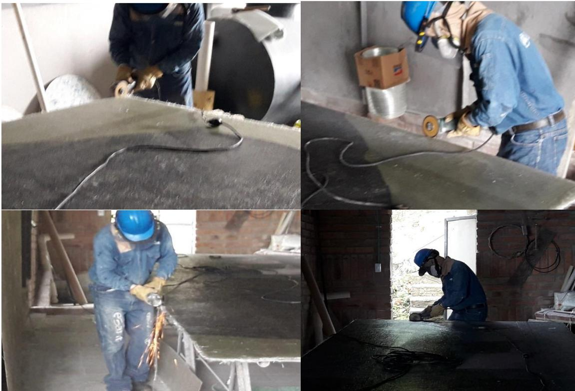
Figura 2. Despegando la lámina de fibra de la mesa donde se fundió
