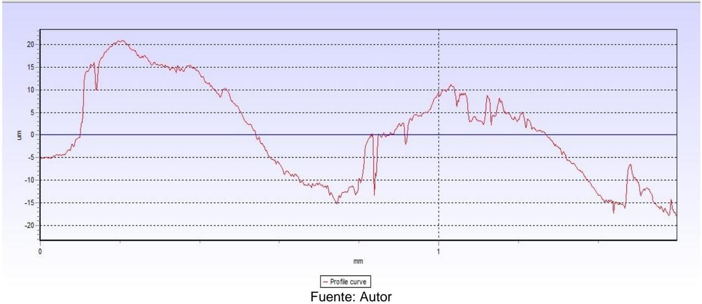
En la figura 47 se puede observar la gráfica de rugosidad del piñón 1 la cual describe los datos tomados (eje X=mm, eje Y=µm), en ella se evidencia el punto o el pico más alto como el RZ (23,400 µm), el RA no se puede observar ya que es una medida media de los valores absolutos en una línea media descritos anteriormente en la página 49.
