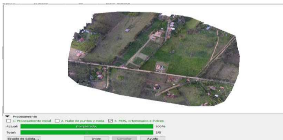
Figura 48. Modelo digital de superficie
