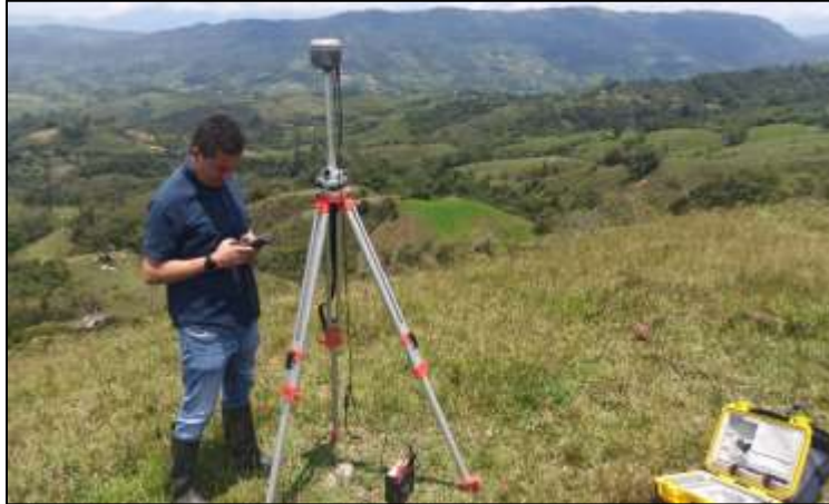
Figura 9. Equipo de topografía GNSS de múltiple frecuencia marca South Galaxy new G1 (equipo gps1)
