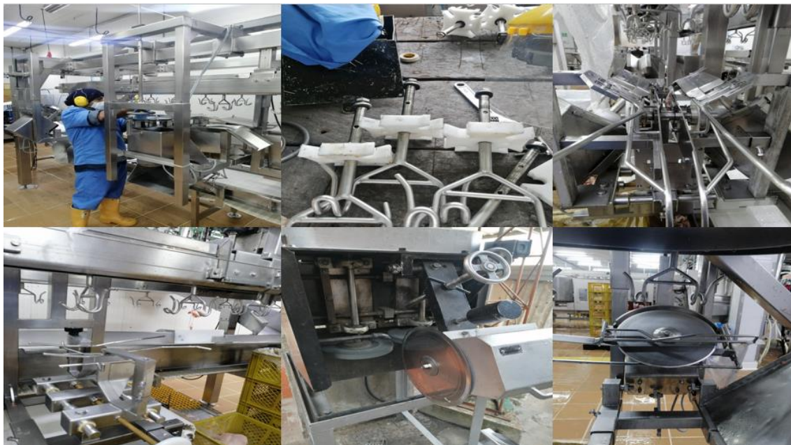
Figura 8. Montaje de cuchillas y revisión de desprese automático.
