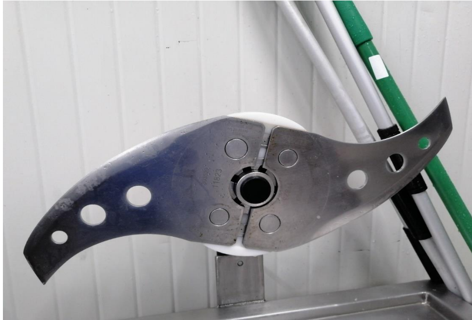
Figura 10. Balanceo cuchillas de supercúter.
