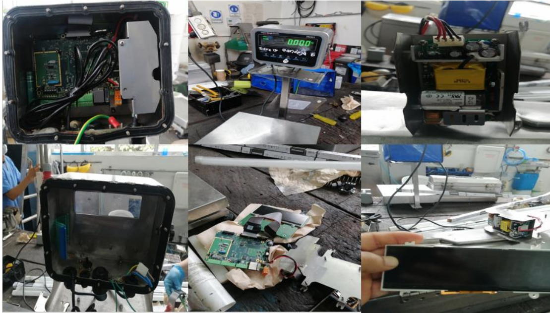
Figura 16. Tablero de control de bascula por separado.
