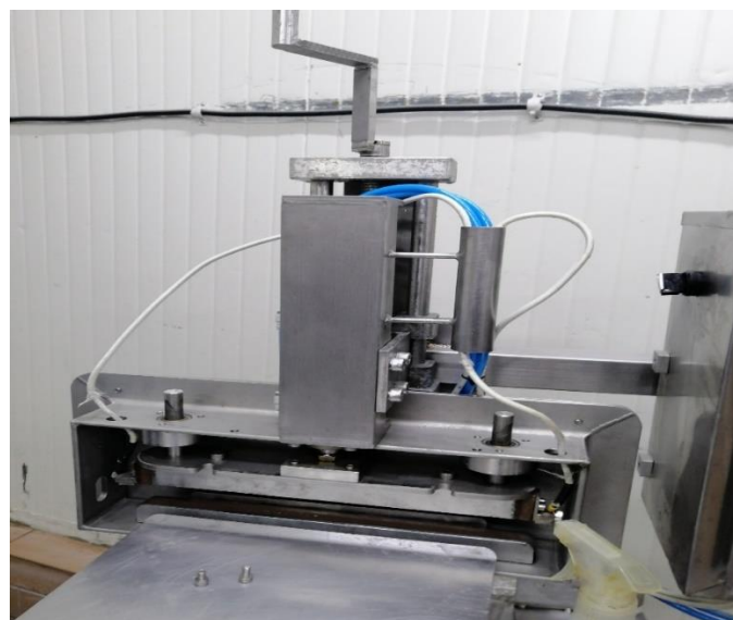
Figura 13. Cableado externo, bloques de selladora.
