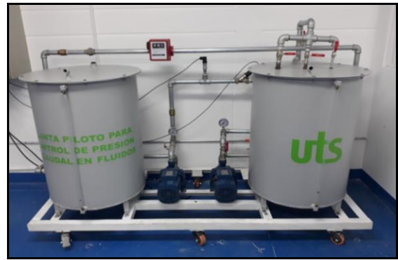
Fig. 6. Planta piloto para control de fluidos
