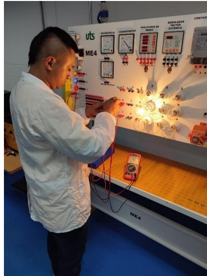
Figura 7 Identificación de fallas de voltímetros análogos y digitales.
