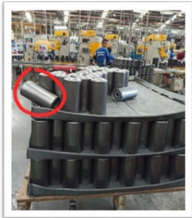
Figura 5. filtro abollado (se cae de la bandeja acumulada)
