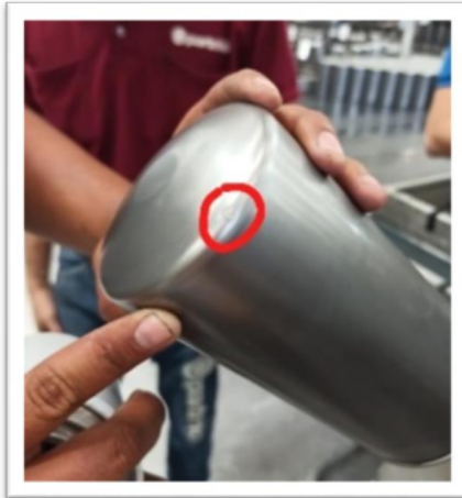
Figura 3. filtro abollado (se cerró con tarro abollado)
