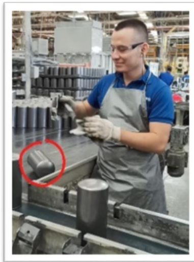
Figura 2. filtro abollado (se resbala de las manos)
