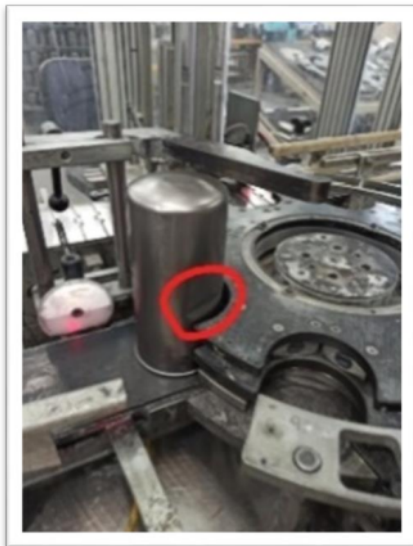
Figura 4. filtro abollado (se estrella con la guía)
