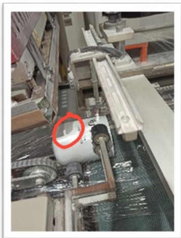
Figura 8. filtro abollado por embolsadora (falta de sensores)
