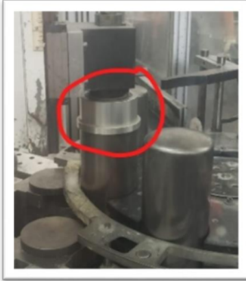
Figura 1. filtro abollado (se estrella con el domo)
