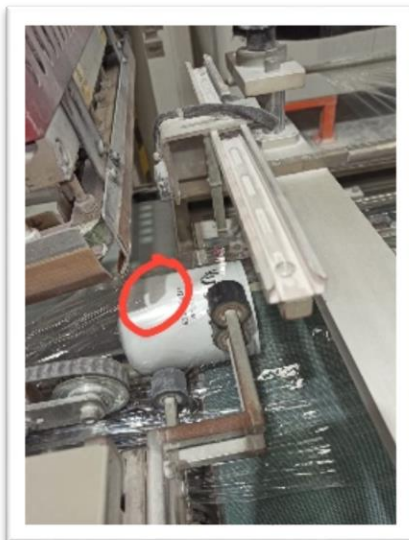
Figura 8. filtro abollado por embolsadora (falla de sensores)
