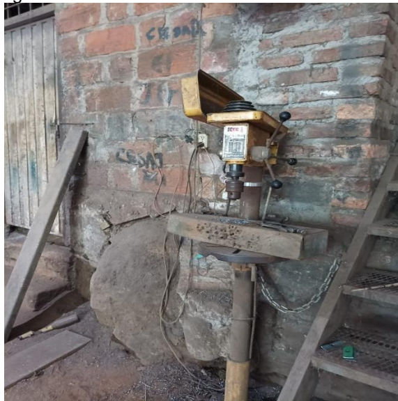
Figura 19. Taladros de árbol en el área de cortado
