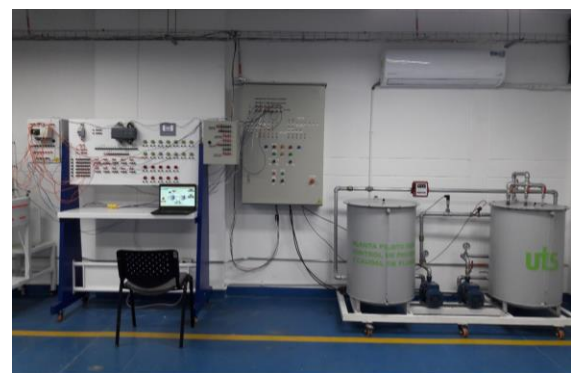
Figura 2. Adaptación del PLC, el equipo portátil y sistema de emulación de riego.
