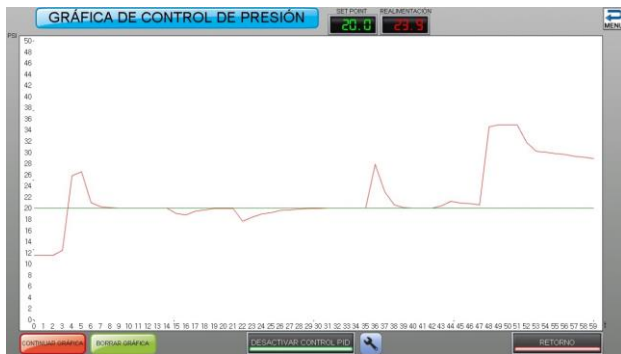
Figura 19. Evaluación del sistema de control PID presión.
