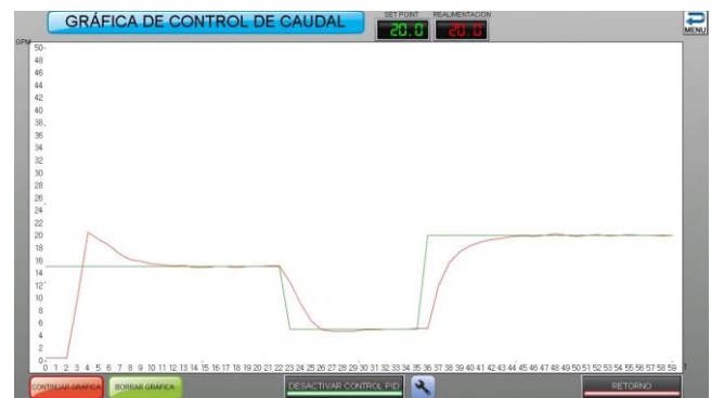
Figura 20. Evaluación del sistema de control PID caudal.
