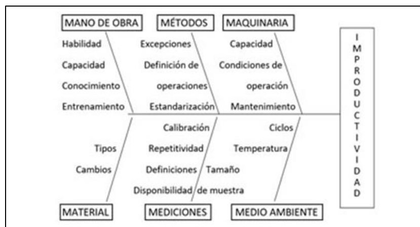
Figura 4. Diagrama de Ishikawa para la cadena productiva del calzado sin uso de Big Data.
