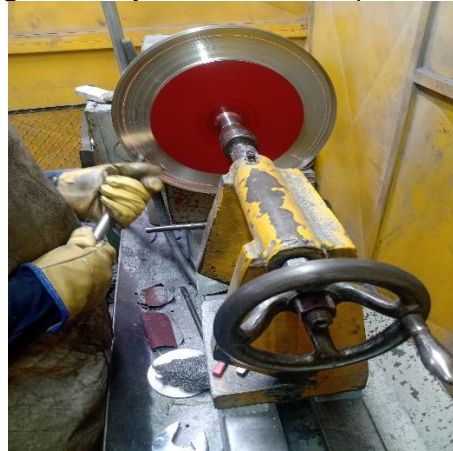
Figura 8. Rayado Interior de Tapa Metálica
