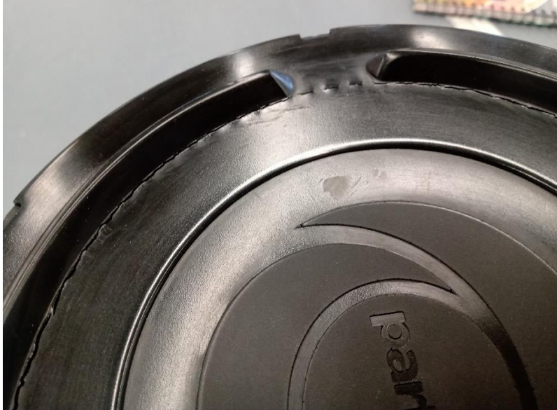
Figura 16. Tapa de Poliuretano Perforada a Raíz de que No se Expandió el Filtro
