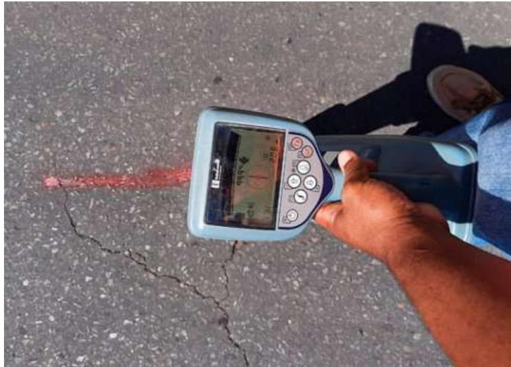
Figura 9. VISUALIZACIÓN DE LA PANTALLA DEL EQUIPO RD.
