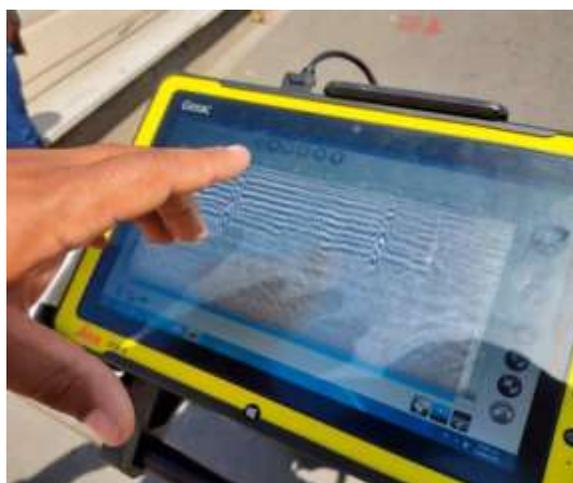
Figura 13. PANTALLA DEL EQUIPO GPR.
