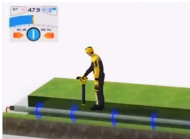
Figura 8. DESPLAZAMIENTO CON EL DETECTOR EM
